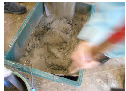
コンクリートの手練り
